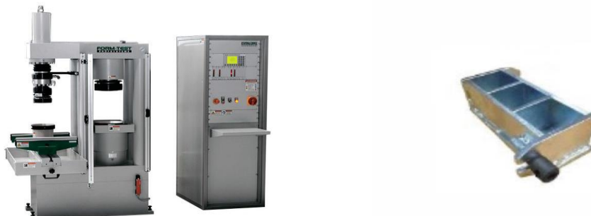
2 Сурет. Беріктігін анықтайтын пресс машинасы және қалыптар
